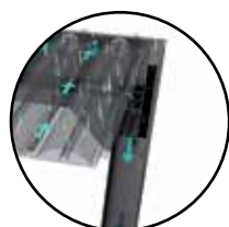
Écoulement par les poteaux d'angle
