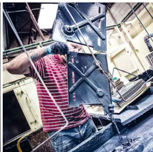
Application de l'émail par pulvérisation (avec pistolet) ou par trempage : 2 à 3 couches sont nécessaires pour obtenir une tenue parfaite de l'émail et un rendu bien lisse.
