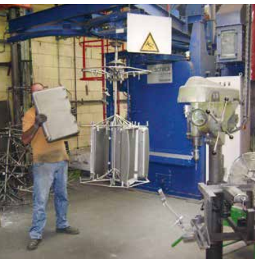
Décapage et préparation de la fonte par grenailage.
